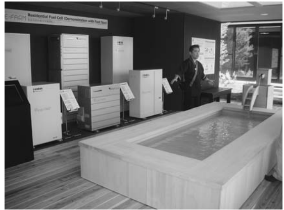
家庭用燃料電池は都市ガス・LPガス・灯油用と3機種を展示。発電によって出る熱は足湯に利用する演出。
