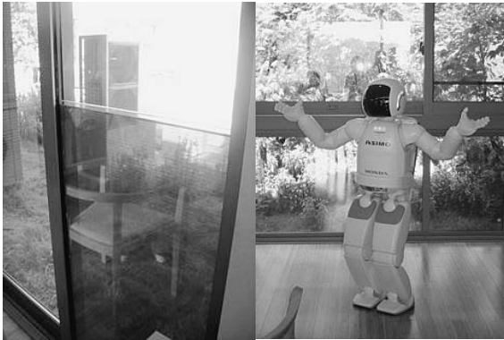
左：発電窓ガラス（日本テレコミュニケーションシステム）日射・紫外線もカットするが、発電効率が課題か。 右：ヒューマノイドロボットASIMO（HONDA）リビングルームでお出迎え、生活空間での活躍を想定して開発されたロボット、御茶出しもしていた！
